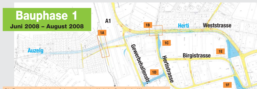
Die Bauarbeiten sind darauf abgestimmt, den Verkehrsfluss in der Weststrasse zu erhalten und die Liegenschaftenerschliessungen jederzeit zu gewährleisten. Als künftige Zufahrt zur Gewerbehallenstrasse entsteht eine Verbindung mit der Hertistrasse.
